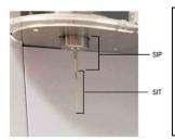
L'échantillon, contenu dans un tube standard de 12 x 75 mm, est introduit dans le cytomètre par le « sample injection tube » (SIT), située dans le « sample injection port » (SIP). Le tube à échantillon s'enclenche en dessous du SIP sans avoir besoin d'un support supplémentaire. La SIT s'étend en dehors du SIP lors de l'acquisition et se rétracte lorsque le cytomètre ne réalise pas d'acquisition.
